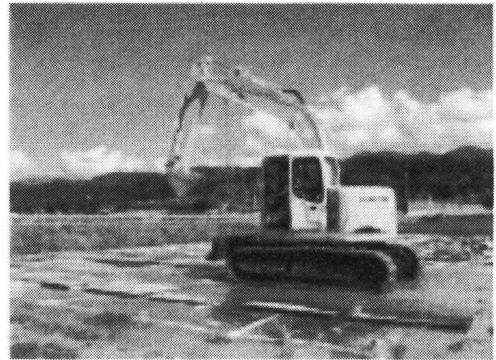
写真-5 重機による走行試験
