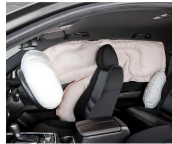
1986年にエアバッグの開発に着手し、1989年に量産を開始。座席サイド部分に内蔵される「サイドエアバッグ」や「カーテンエアバッグ」等、正面衝突以外の衝撃を緩和するための多種多様なエアバッグを製造しています。
