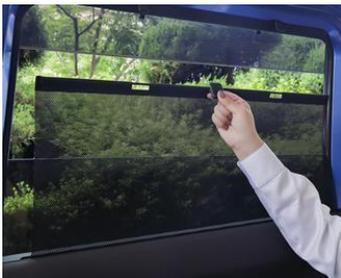
ドアトリム内にビルトインされた巻取り式ドアシェードです。使用時以外はドアトリム内に巻き取るため視界を遮ることがなく、また上端まで閉めればプライバシーを守ることができます。
