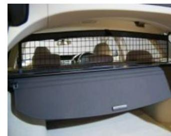
乗員スペースとラゲージルームを仕切るネットで、急制動時に乗員スペースへの荷物の進入、荷くずれを防止し、乗員を守ります。
