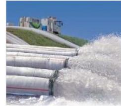
水害や災害の現場で排水ポンプ車がすぐに使用できるように軽量化した緊急排水対策用ホースです。
