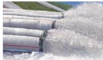
水害や災害の現場で排水ポンプ車がすぐに使用できるように軽量化した緊急排水対策用ホースです。
