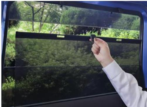
ドアトリム内にビルトインされた巻取り式ドアシェードです。使用時以外はドアトリム内に巻き取るため視界を遮ることがなく、また上端まで閉めればプライバシーを守ることができます。
