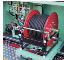
油圧PTO式 50m手動リール積載 救助工作車
