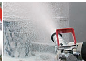
消火薬剤混合発砲放射 射程 6~10m
