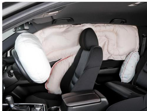
1986年にエアバッグの開発に着手し、1989年に量産を開始。座席サイド部分に内蔵される「サイドエアバッグ」や「カーテンエアバッグ」等、正面衝突以外の衝撃を緩和するための多種多様なエアバッグを製造しています。
