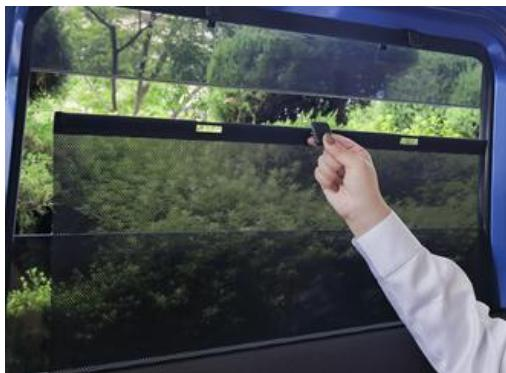
ドアトリム内にビルトインされた巻き取り式ドアシェードです。使用時以外はドアトリム内に巻き取るため視界を遮ることがなく、また上端まで閉めればプライバシーを守ることができます。
