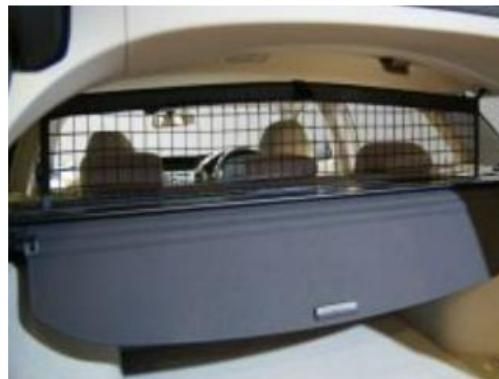
乗員スペースとラゲージルームを仕切るネットで、急制動時に乗員スペースへの荷物の進入、荷くずれを防止し、乗員を守ります。
