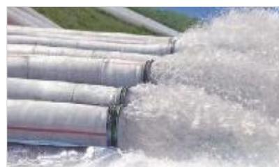
水害や災害の現場で排水ポンプ車がすぐに使用できるように軽量化した緊急排水対策用ホースです。
